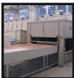
Pressa a membrana riveste a caldo gli arredi per renderli più resistenti
